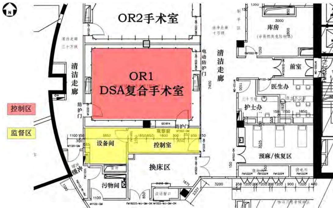
图 3-4 国际神经科学研究所地下一层手术室 1（DSA 机房）平面布局示意图
